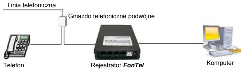
Przykład podłączenia rejestratora do linii telefonicznej zakończonej podwójnym gniazdem telefonicznym
