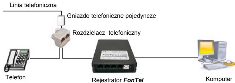
Przykład podłączenia rejestratora do linii telefonicznej zakończonej pojedynczym gniazdem telefonicznym, z użyciem rozdzielacza telefonicznego
